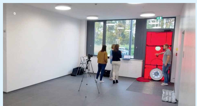
Im eingebauten Zustand fördert ein Ventilator Luft aus dem Gebäude. Undichte Stellen lassen sich dann schnell finden, zum Beispiel an Fenstern oder Übergängen von Wänden und Dach.
