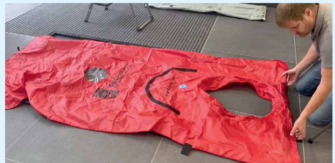
Sorgfältig spannt Laboringenieur Dipl.-Ing. Oliver Abel die luftdichte Plane über den Spannrahmen, bevor dieser in eine Tür oder ein Fenster für den Blower-Door-Test eingebracht wird.
